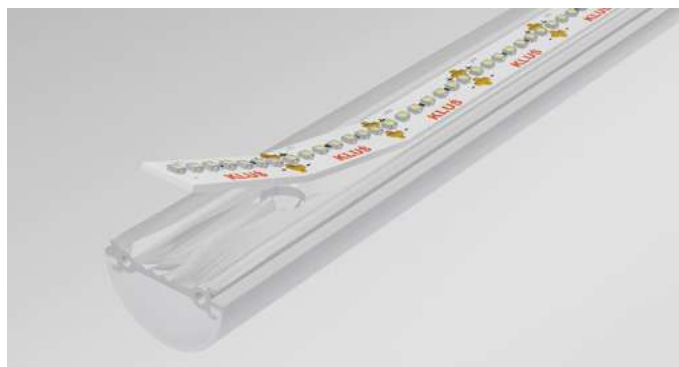
Sharp edges can damage the LED strip. Make sure the mounting surface is smooth before applying the LED strip. / Los bordes afilados puede dañar la tira de LED. Asegúrese de que la superficie de montaje esté lisa antes de aplicar la tira de LED.
